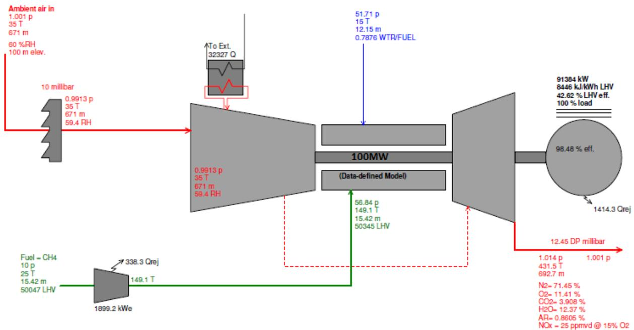
**Fig 5. GAS TURBINE HMBD FOR INLET AIR TEMPERATURE 25°C FROM GR PRO**
